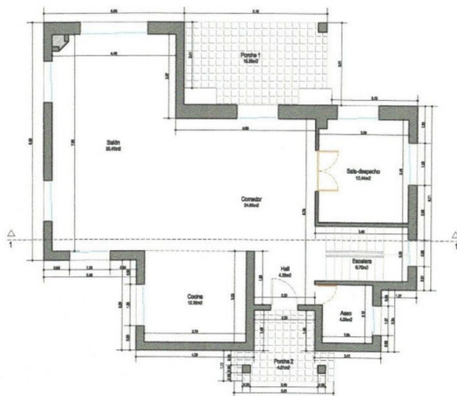
VIVIENDA P. BAJA Sup. Cerrada Vivienda = 122,90m 2 Sup. Cubierta Porches (computa 50%) = 19,60m 2 Sup. Construida = 132,70m 2
