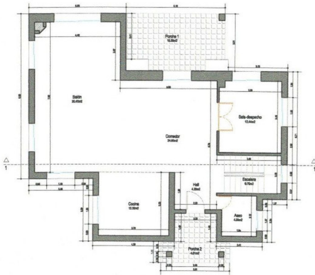
VIVIENDA P. BAJA Sup. Cerrada Vivienda = 122.70m 2 Sup. Cubierta Panchos (campaña 50%) = 19.60m 2 Sup. Construida = 132.70m 2
